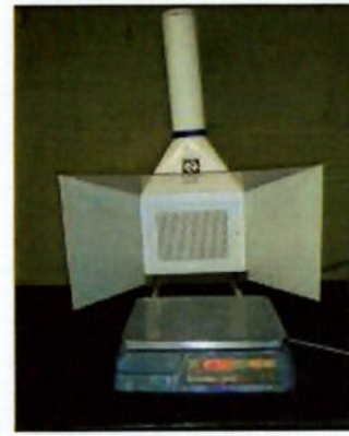
Figura 30 – Capela para exaustão de pó na área de pesagem.
