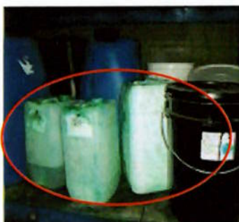
Figura 3 – Matérias primas fracionadas em embalagens inadequadas e com identificação danificada.
